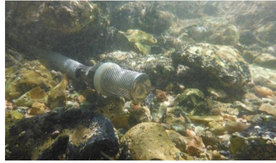
Figure 5 : Crépine de prélèvement située dans le cours d'eau à prélever (évite l'intrusion d'éléments grossiers) - station amont.
